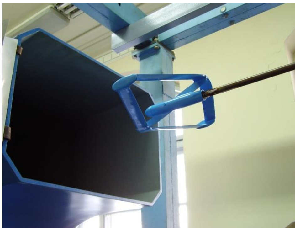
Фиг. 3.5.4 Изпитване на МСК-2 в АДТ
