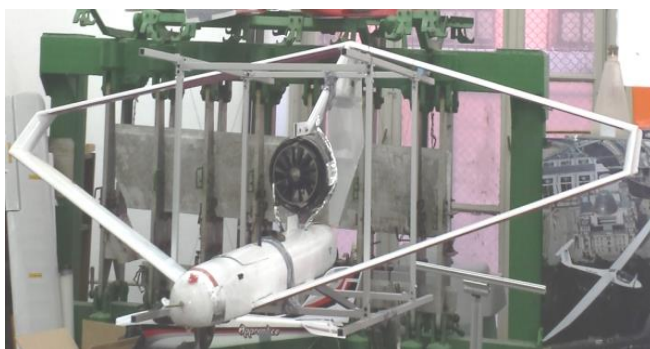
Фиг 3.6.4. Измерване на инерционни моменти на БЛА СК на стенда в лабораторията за БЛА
