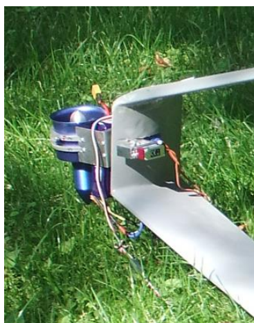
Фиг. 3.7.12 Фрагмент от крило с управляващ двигател
